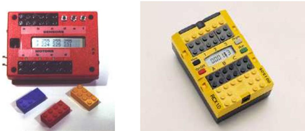
FIG. 3.1 – Brique programmable du MIT et brique LEGO RCX.
